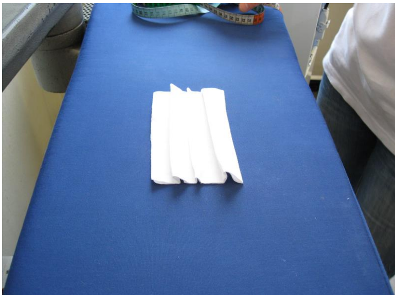
In das Stofftuch 3 gleichmäßig verteilte Falten bügeln (Faltentiefe 1,3 cm)
